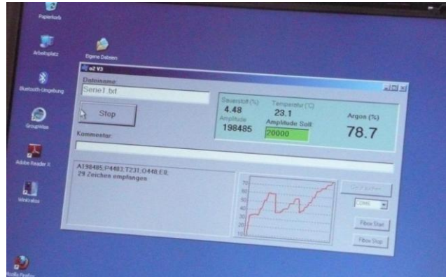
Auslesen und Ermitteln des Gasfüllgrades
