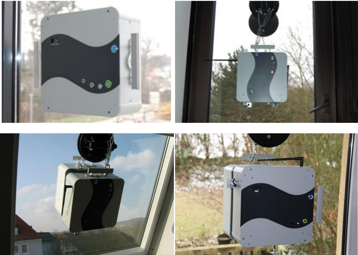
Abb. 3: Prototyp des U g lass -Sensors (links oben) und erste Feldtests in zwei Bestandsgebäuden des Projektträgers Jülich aus den Jahren 1982 und 2010 (rechts oben), einem Wohngebäude, das 2005 saniert wurde (unten links) sowie einem Wohngebäude mit neuen Fenstern aus dem Jahr 2011 (unten rechts). Bei den Feldtests wurde noch eine behelfsmäßige Absturzsicherung für die Sensorhälften verwendet.
